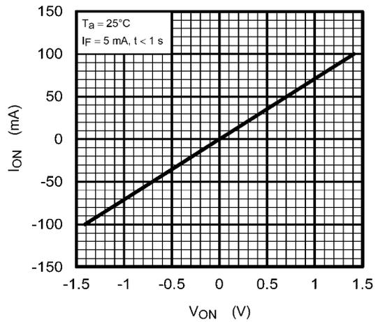
**Fig. 12.4 I<sub>ON</sub> - V<sub>ON</sub>**
