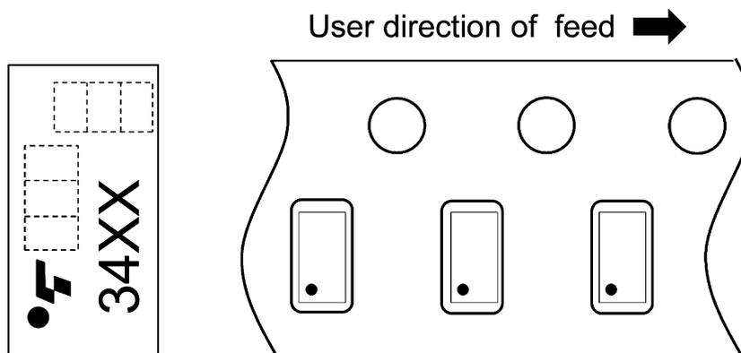
Fig. 16.3.1.1 Device Orientation
