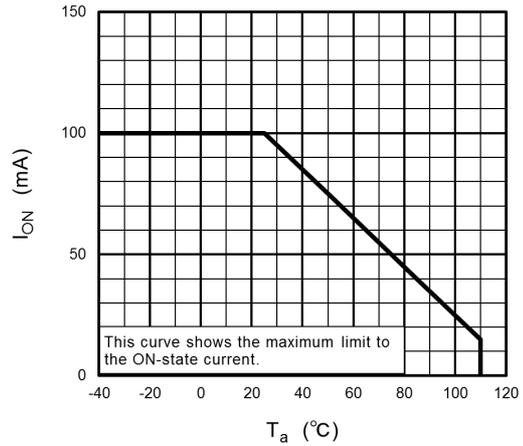
**Fig. 12.2 I<sub>ON</sub> - T<sub>a</sub>**
