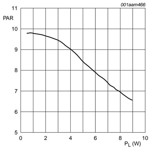
$V_{DS} = 28\text{ V}$ ;  $I_{Dq} = 345\text{ mA}$ ;  $f = 2140\text{ MHz}$ .
