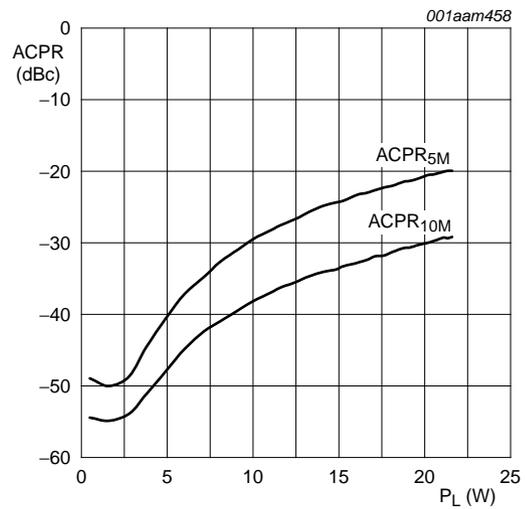
$V_{DS} = 28\text{ V}$ ;  $I_{Dq} = 345\text{ mA}$ ;  $f = 2140\text{ MHz}$ .
