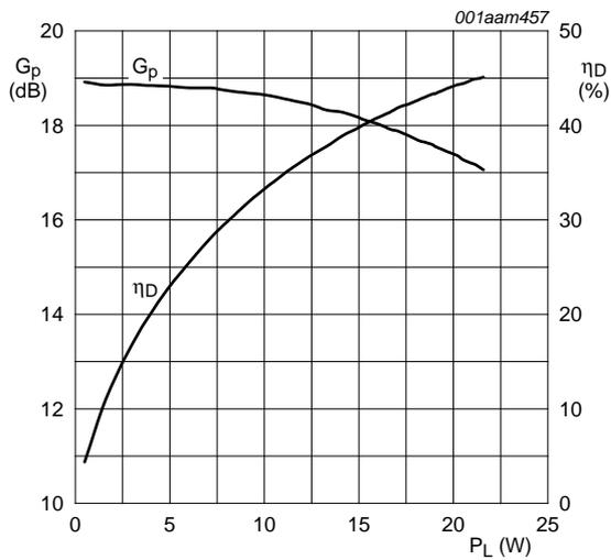
$V_{DS} = 28\text{ V}$ ;  $I_{Dq} = 345\text{ mA}$ ;  $f = 2140\text{ MHz}$ .
