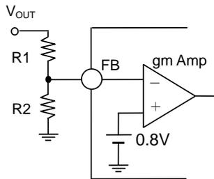
$$V_{OUT} = \frac{R1 + R2}{R2} \times 0.8 [V]$$
