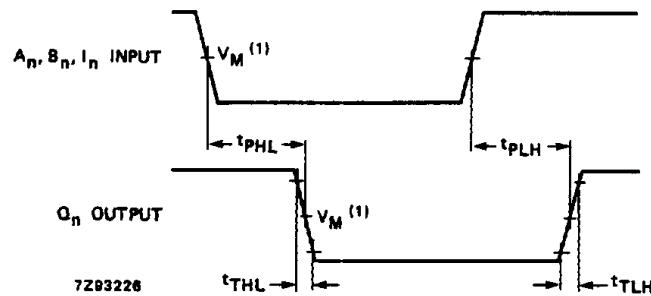
(1) HC :  $V_M = 50\%$ ;  $V_I = \text{GND to } V_{CC}$ .
