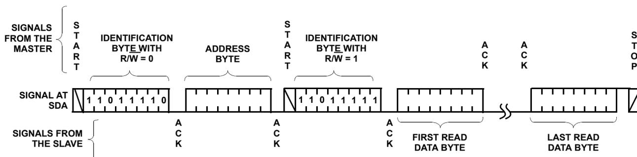
FIGURE 20. READ SEQUENCE (CSR SLAVE ADDRESS SHOWN)
