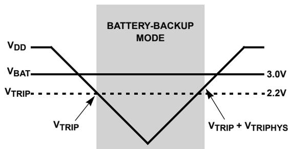
FIGURE 14. BATTERY SWITCHOVER WHEN  $V_{BAT} > V_{TRIP}$
