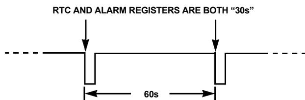
**FIGURE 15.  $\overline{\text{IRQ}}/\text{F}_{\text{OUT}}$  WAVEFORM**
