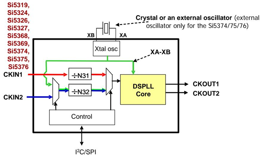
**Figure 26. Free Run Mode Block Diagram**
