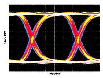
FIGURE 6. QLX4600-S30 OUTPUT AFTER 20m OF 24AWG TWIN-AXIAL CABLE (CABLE A), 5Gb/s
