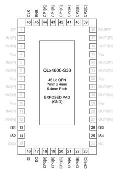
FIGURE 27. PIN DIAGRAM HIGHLIGHTING PINS USED FOR DYNAMIC CONTROL OF THE QLX4600-S30
