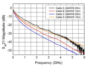
FIGURE 3. TWIN-AXIAL CABLE LOSS AS A FUNCTION OF FREQUENCY FOR VARIOUS TEST CHANNELS
