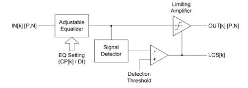
FIGURE 23. FUNCTIONAL DIAGRAM OF A SINGLE CHANNEL WITHIN THE QLX4600-S30
