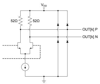
FIGURE 26. CML OUTPUT EQUIVALENT CIRCUIT FOR THE QLX4600-S30
