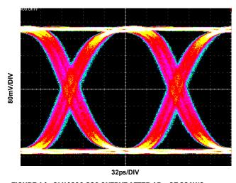
FIGURE 14. QLX4600-S30 OUTPUT AFTER 15m OF 28AWG
