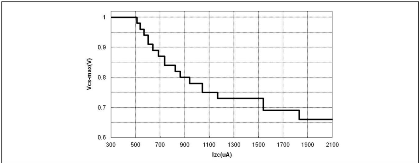
**Figure 8** V<sub>CS\_max</sub> versus I<sub>ZC</sub>
