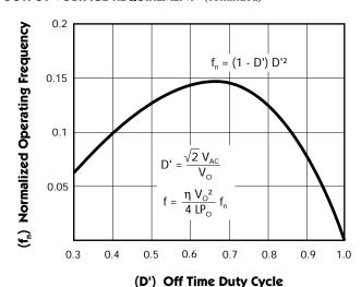
FIGURE 32 — NORMALIZED OPERATING FREQUENCY vs. OFF-TIME DUTY CYCLE
