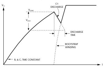
FIGURE 25 — START-UP CAPACITOR VOLTAGE
