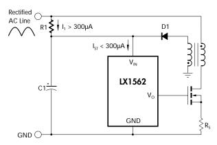
FIGURE 24 — TYPICAL APPLICATION OF START-UP CIRCUITRY
