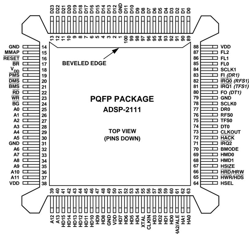
NOTE: PIN 1 IS LOCATED AT THE CENTER OF THE BEVELED-EDGE SIDE OF THE PACKAGE.
