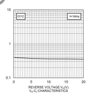
CAPACITANCE BETWEEN TERMINALS:C<sub>f</sub>(pF)
