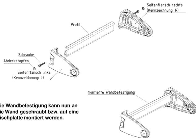
Die Wandbefestigung kann nun an die Wand geschraubt bzw. auf eine Tischplatte montiert werden.
