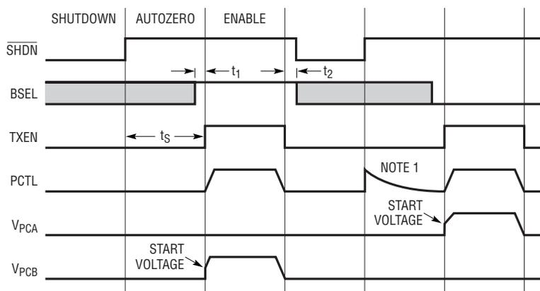
$t_s$ : AUTOZERO SETTLING TIME, 50μs MINIMUM
