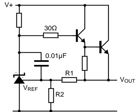
$$V_{OUT} = \left(1 + \frac{R1}{R2}\right) V_{REF}$$
