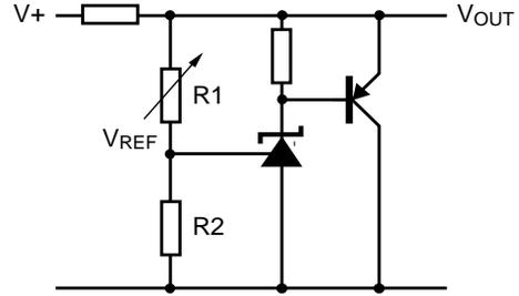
$$V_{OUT} = \left(1 + \frac{R1}{R2}\right) V_{REF}$$
