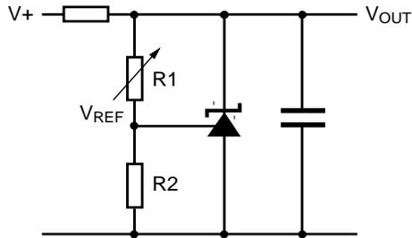
$$V_{OUT} = \left(1 + \frac{R1}{R2}\right) V_{REF}$$
